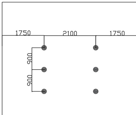
DIAMETRE RONDIN : 100 mm POUTRE ECHELLE DE SUSPENSION : 90 x 68
